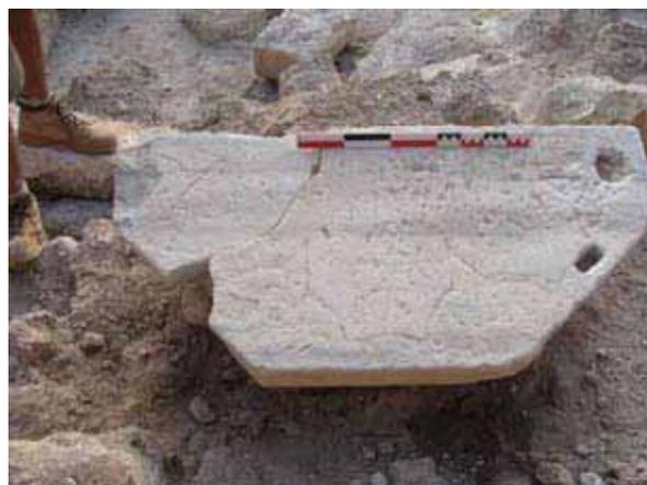
**Figure 129 : Dessus d'un chapiteau du premier étage, avec dessin de pose des claveaux engravé**
